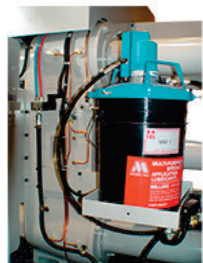
Sistema de Lubrificação Automática por Graxa
