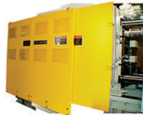
Sistema de Porta Automática Elétrica Lado Operador
