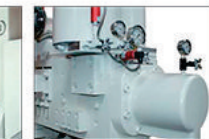
Escala de controle de velocidade do pistão da injeção com sensor de pressão.
